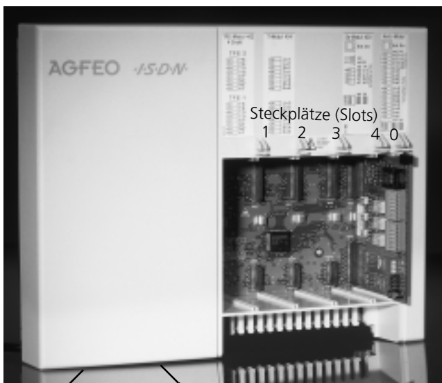
Abb. 1 TK-Anlage mit abgenommenem Deckel
