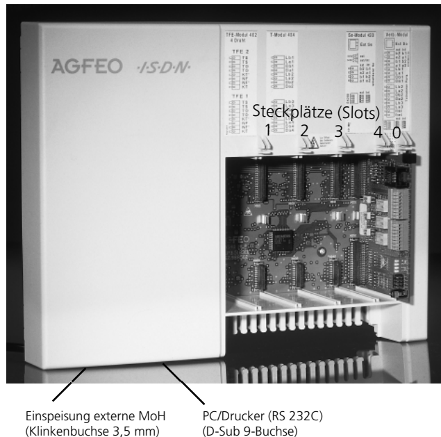
Abb. 1 TK-Anlage mit abgenommenem Deckel
