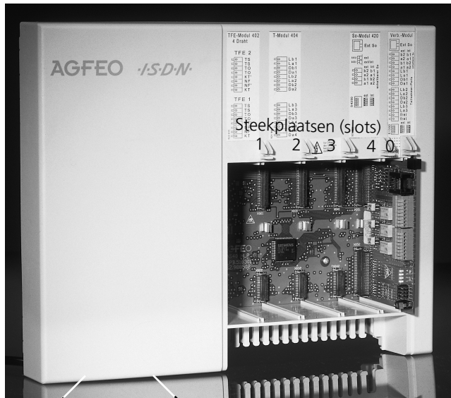
Afb. 1: Telefooninstallatie met afgenomen deksel
