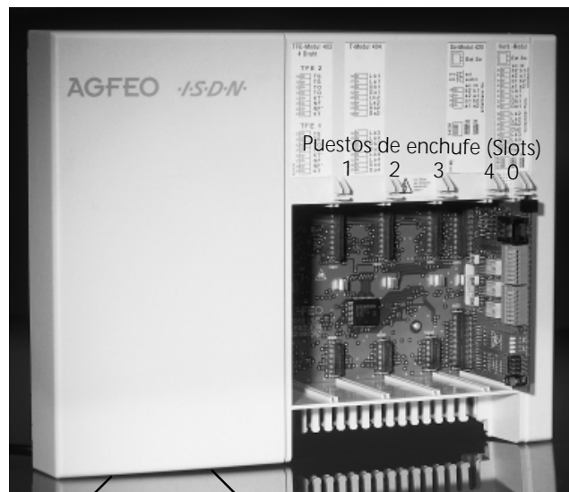
Fig. 1 Instalación de telecomunicación con tapa quitada
